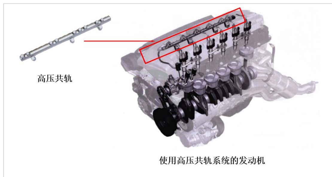
图：高压共轨在汽车发动机中的位置示意图
