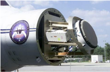
c. 机载火控雷达 APG-81（空基）
