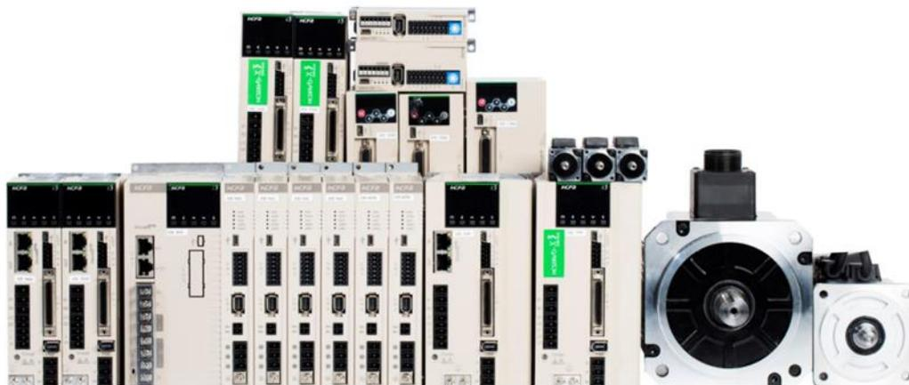
伺服系统由伺服驱动器发出信号给伺服电机驱动其转动,同时编码器将伺服电机的运动参数反馈给伺服驱动器,伺服驱动器再对信号进行汇总、分析、修正。整个工作过程通过闭环方式精确控制执行机构的位置、速度、转矩等输出变量。
