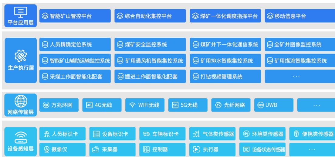
公司的智能矿山系统主要是以生产执行层的应用场景需求为中心，进行设备感知层和网络传输层的软硬件开发与搭建，并进一步形成相关的智能矿山平台应用。经过多年的技术延伸及产业发展，公司目前已经拥有智能矿山通信、监控、集控及装备配套四大类产品，形成了较为完善的产品体系，涵盖了多个针对特定煤矿应用场景的系统，具体情况如下：
