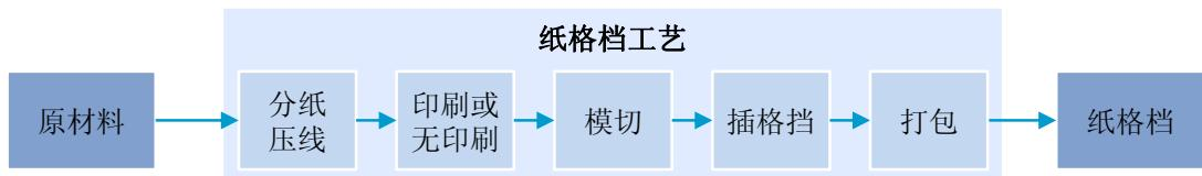
**3) 异形瓦楞纸箱与纸附件生产工艺流程**
