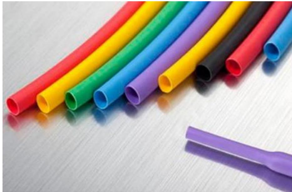
公司所生产 PVC 热缩套管由 PVC (聚氯乙烯) 树脂粉, 配以颜料、塑料增塑剂等辅料, 经高速捏合、挤出、正压扩张、冷却而成型, 它利用的是塑料的“记忆还原”效应, 达到加热收缩的效果。PVC 热缩套管具有环保 (符合欧盟 RoHs 指令) 、绝缘的特点, 广泛应用于电解电容器、电感等电子产品和各种电池、灯饰、线束、母排的绝缘外包覆, 对产品能起到防潮、绝缘、美观的效果。并可用于伸缩杆、浴帘杆, 五金家具等铁管的外包塑, 替代喷涂, 提高生产效率, 使生产综合成本降低, 减少环境污染。
