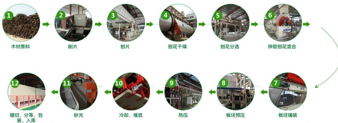
①削片工段：将挑拣后的枝丫材、锯末等主要原材料经运输机送到削片机中打成宽度约1.5-3厘米、长度约3-4厘米的片状。
