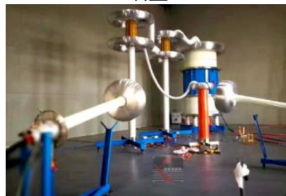
电缆介质损耗测量
