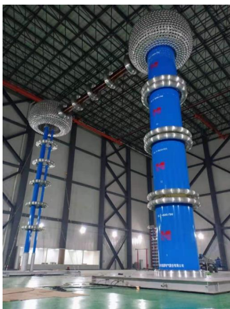
2400kV/50mA 积木圆筒式直流试验系统
