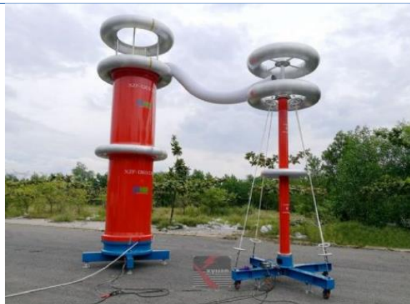
460kV,2530kVA 电力测试装置
