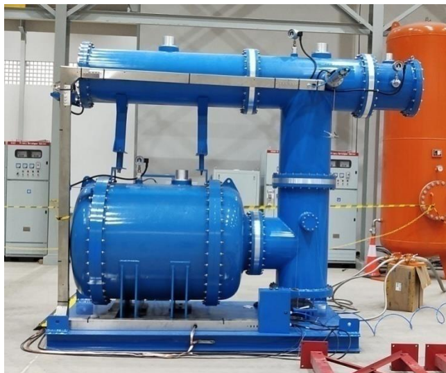
YDQW-200kVA/400KV SF 6 气体绝缘试验变压器
