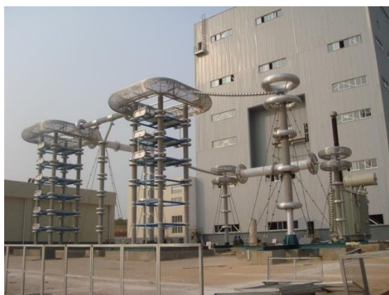
\pm 1000\text{kV}/2\text{A} 直流污秽成套试验装置 (现已升级为 \pm 1400\text{kV}/2\text{A} 直流污秽电源)
