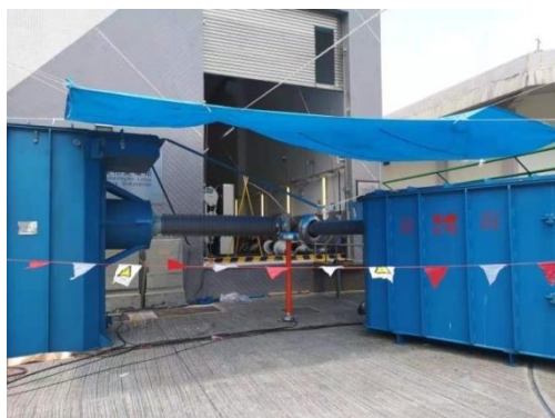
GK-260kV/83A 谐振电抗器及试验现场
