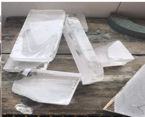
图 4:解料后的光学玻璃残体
