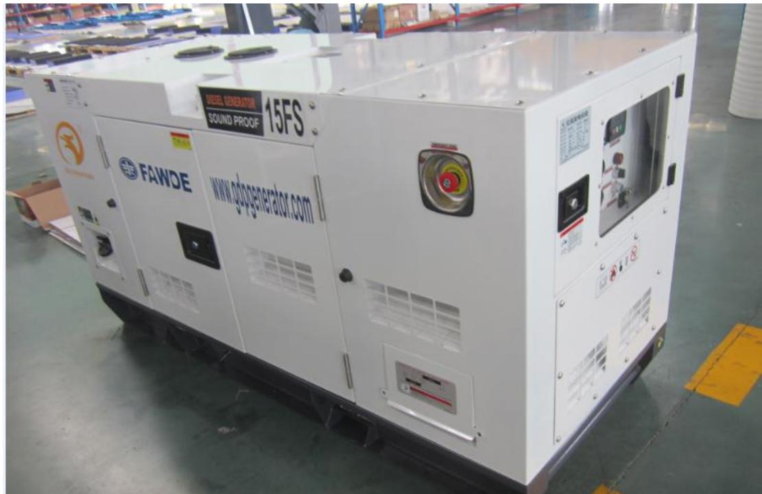
**特点：**超静音型柴油发电机组的主要产品特点为静音效果良好、结构紧凑。通过对柴油发电机组的噪音分析，发掘噪音音源，针对每个噪声源采用不同的设计及改造，采用阻抗式消声器，将阻性消声器和抗性消声器的消声原理通过适当结构进行组合，兼有两者的消声特性，大大提高了降噪效果；水箱挡板将机组和消声器隔开，使得消声器运行所产生的高温不会影响机组的正常工作，同时阻止了发电机声音的外泄；产品设计采用导风斜板，在每个进风口的背面都加装了导风隔音板，加长风道，同时在机箱底部加铺吸音棉，大大降低了内部机组噪音的排出。
