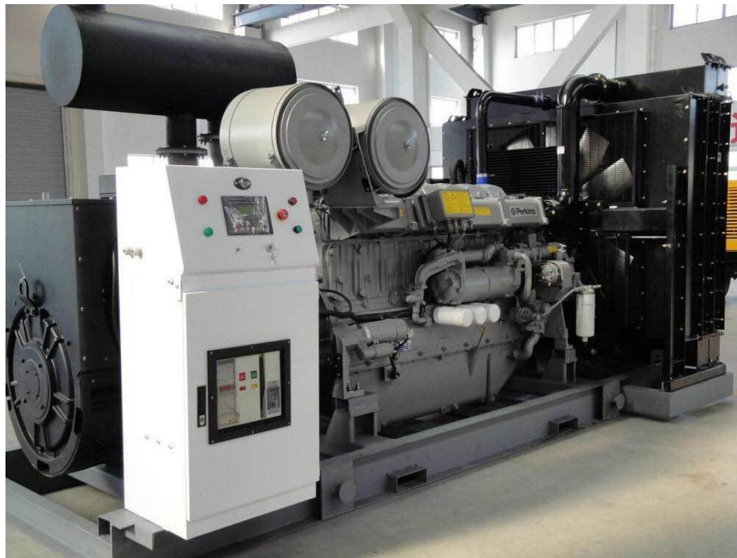
**特点：**机组总体重量轻，体积小，底盘采用钢板折弯焊接框架结构，强度高；大容量燃油箱，满足机组额定负荷下8小时连续工作；分开式控制箱和开关柜，操作简单，维护保养方便，配套的品牌发动机和品牌发电机及全固封的自动电压调节器，运行可靠。
