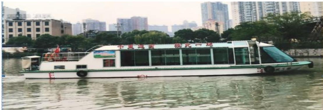
全景式商务游船，全景玻璃封闭式船舱，船长 13.42 米、宽 3.8 米、高 3.2 米，载客 32 坐-40 坐，C 级航区 5 艘，B 级航区 1 艘，共 6 艘。
