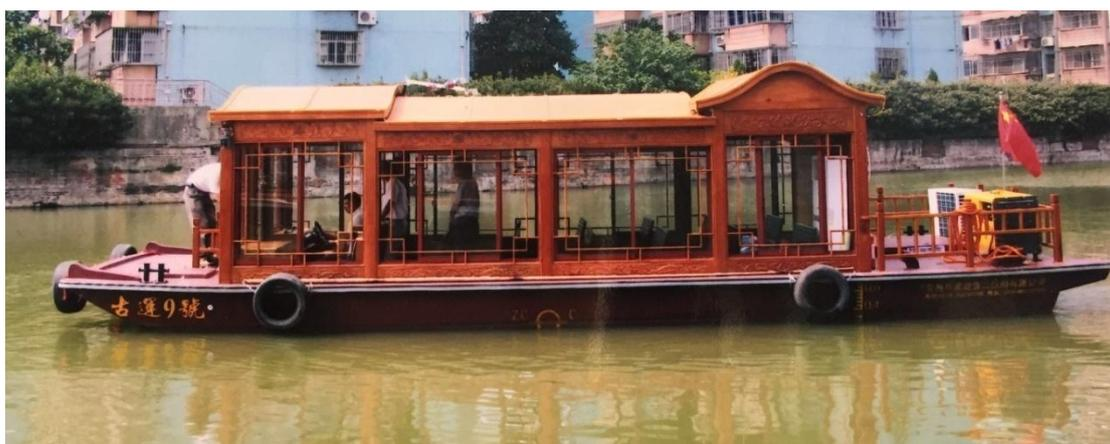
小型画舫船，古色古香，封闭式船舱，长 10.8 米、宽 3.2 米、高 2.78 米，载客 25 位，C 级航区，共 10 艘。
