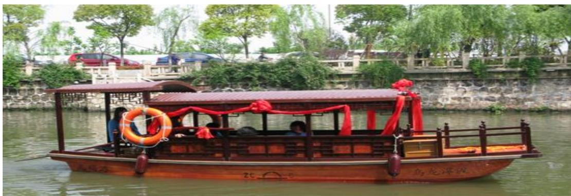
敞开式 10 人以下的小摇橹船，可以人工摇橹，也可以加装小型舷外机。船长 5.67 米、宽 2 米、高 2 米，C 级航区，共 15 艘。
