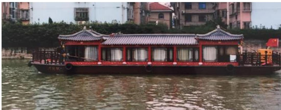
中型画舫船，古色古香，封闭式船舱，长 18.13 米、宽 4.2 米、高 3.45 米，载客 33-48 位，C 级航区 9 艘，B 级航区 1 艘，共 10 艘。
