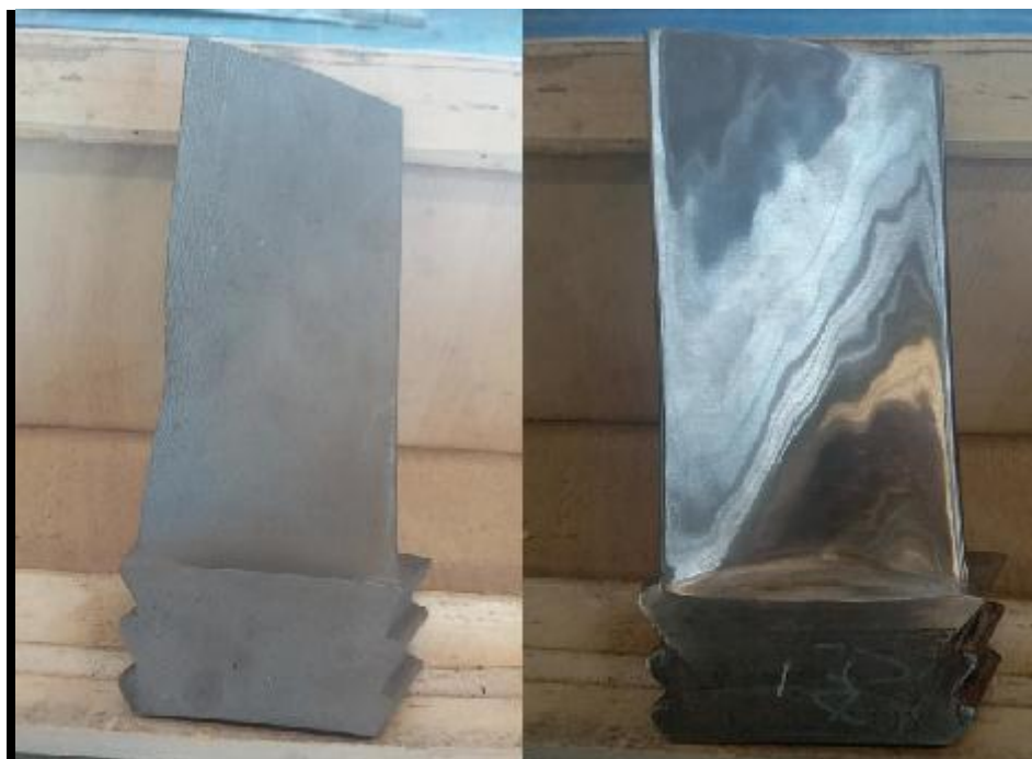
图 1 旧叶片（左）、再制造后（右）
