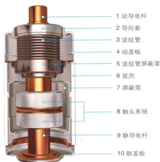
真空灭弧室的基本结构
