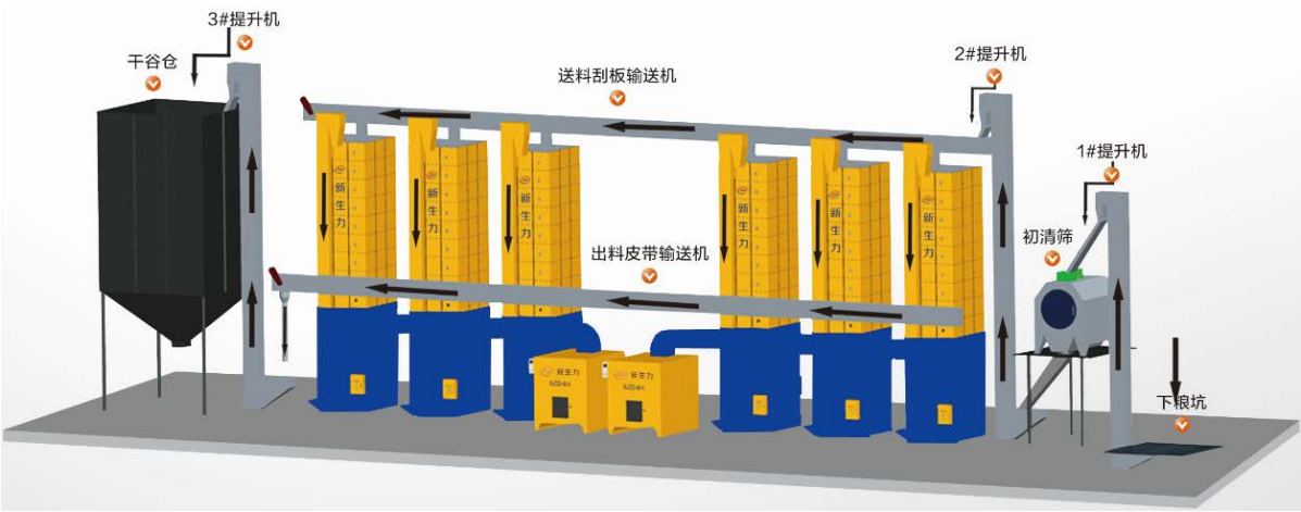
①谷物干燥成套设备的作业流程示意图
