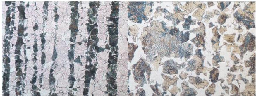
如上图所示，为两种不同原材料的金相组织，左侧的材料虽然存在明显的带状组织，但在球化退火工艺后，晶粒变得细小，成形件质量较好。而右侧的材料微观组织晶粒粗大，在成形过程中发生了疏孔的现象，如下左图所示。右图为通过溶液腐蚀后得到的低倍组织，流线完整，成形质量好。
