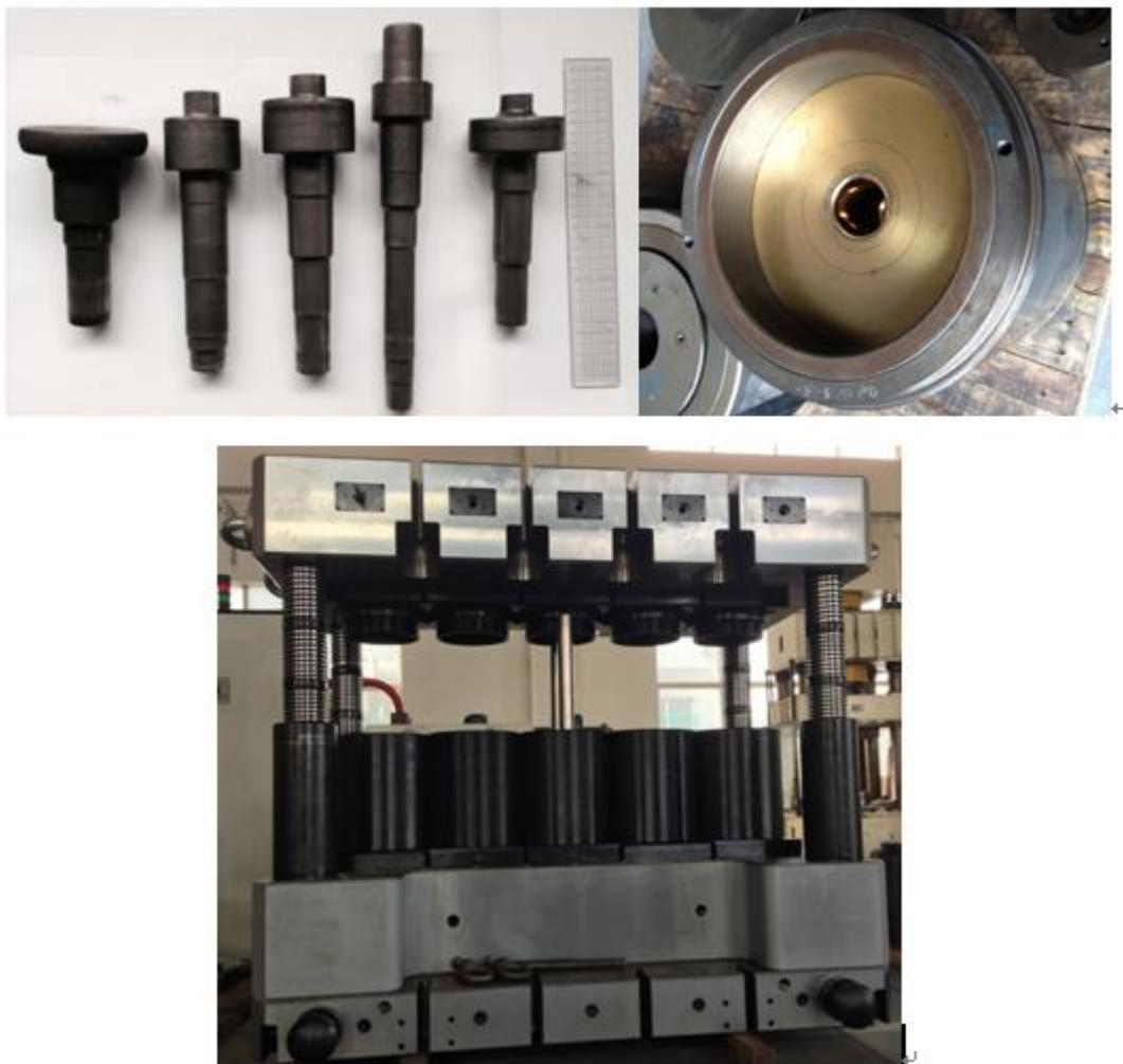
公司为客户提供整套的工艺设计、模具设计、模架设计以及模具加工、模架加工。如下图所示，为某一型号的某一工位的装配图，在设计过程中，要考虑机械手的自动化搬运，结合压力机设备的压力曲线、上、下顶杆的运动曲线，各工位的工件初始位置以及顶出位置均应在同一平面，从而决定模具的具体位置。
