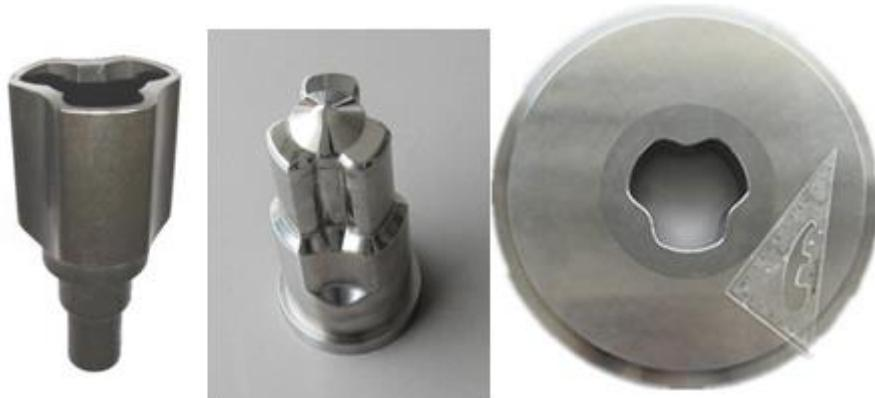
如上图所示，此锻件为等速万向节系统中使用的滑套，右侧为冲头及凹模。冲头材料采用高速钢，头部有 3-5mm 的工作带，表面粗糙度在 Ra0.04 以内。凹模采用预应力组合凹模形式，模芯采用硬质合金，硬度达到 HRA83-88，外套采用 H13 材料，模芯工作部分粗糙度要求在 Ra0.04 以内。
