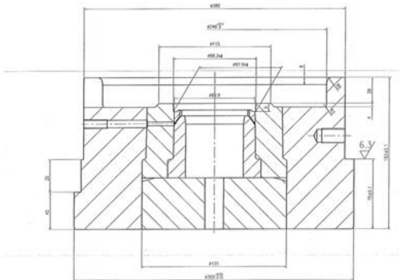
分体式的结合齿，为结合齿圈，其形状如下所示，模具照片如右图。该齿圈的特点是齿的上端部有成形倒角，齿面有锥度。采用冷锻工艺成形，分为预锻成形及倒锥精整成形两部分。模具采用组合凹模形式，模芯为硬质合金材料，外圈为热作模具钢 H13 材料。
