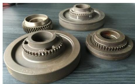
整体结合齿轮如上所示，齿面有倒锥角，且外法兰外径较大，有些类型的结合齿轮还带有 pocket，成形难度较大。如下图所示，为某类型结合齿的模具示意图，模具由模芯及外套压配而成，模芯有与结合齿对应的齿形型腔，每个齿的根部均有排气孔的设计。
