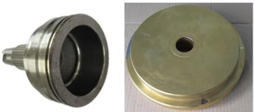
上图为传动轴系统内某传动零件，其主要特点是花键采用冷挤压的方式挤压而成，齿形精度要求极高，跨棒距尺寸公差需要控制在 0.01 以内。为了提高模具寿命，模具研磨后，还需要进行表面涂层处理。
