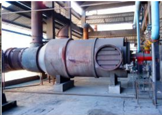
云锡发生炉煤气热风炉应用现场
