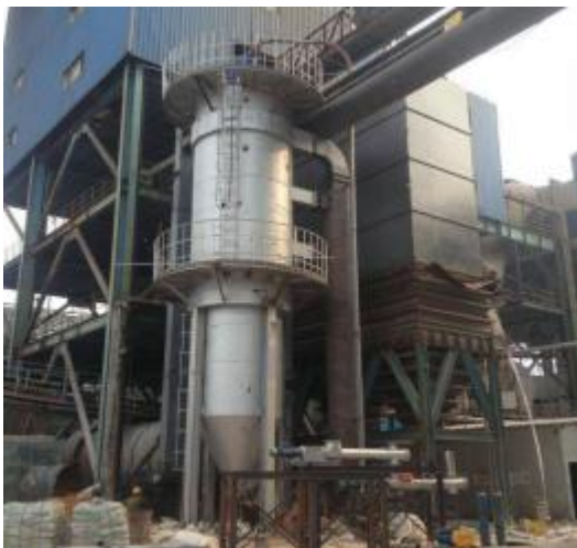
1200×104kcal/h 立式煤粉热风炉应用现场
