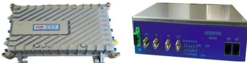
将来自光接收机的 RF 信号与来自于 EPON 或光纤收发器系统的 IP 信号通过 ONU 传送到 EOC 模块调制到 RF 后混合传输，同轴电缆分配网将混合射频信号传到用户处的所有有线电视接口，然后利用 EOC 用户终端设备将数据分离出后送到用户的电脑或双向机顶盒，有线电视信号连接到用户的电视机。组成最后一公里高速互联接入网解决方案，便于进行有线电视网络双向改造，有效发挥有线电视网络的高带宽、低成本、易普及等优势。
