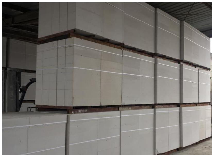
蒸压加气混凝土砌块具有轻质、高强度、保温、节能、节土、装饰等优良特性。从建筑结构来讲，墙体是建筑的最重要组成部分，也是关系建筑物性能和使用寿命的关键因素，而索纳塔蒸压加气混凝土砌块的使用在很大程度上促进建筑节能，减轻建筑物自重，对于房屋结构设计以及提高建筑经济性具有重要的意义。
