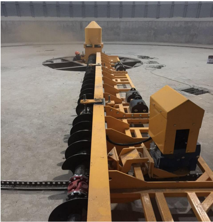
公司为益海（连云港）粮油工业有限公司研发的轨道式清仓机
