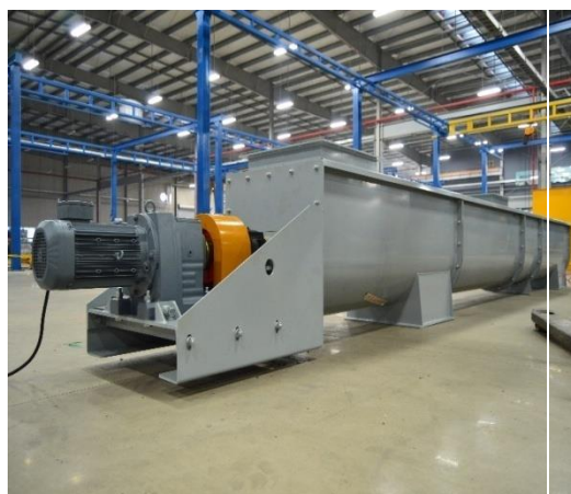
公司为益海嘉里（哈尔滨）粮油食品工业有限 公司研发的螺旋输送机
