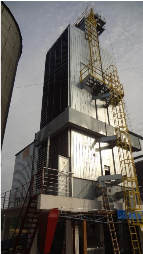
公司为江苏省农垦农业发展股份有限公司新曹分公司研制的连续式干燥机
