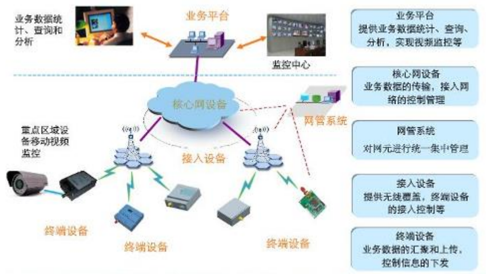
B、TD-LTE 无线宽带的用电信息采集系统拓扑图如下：
