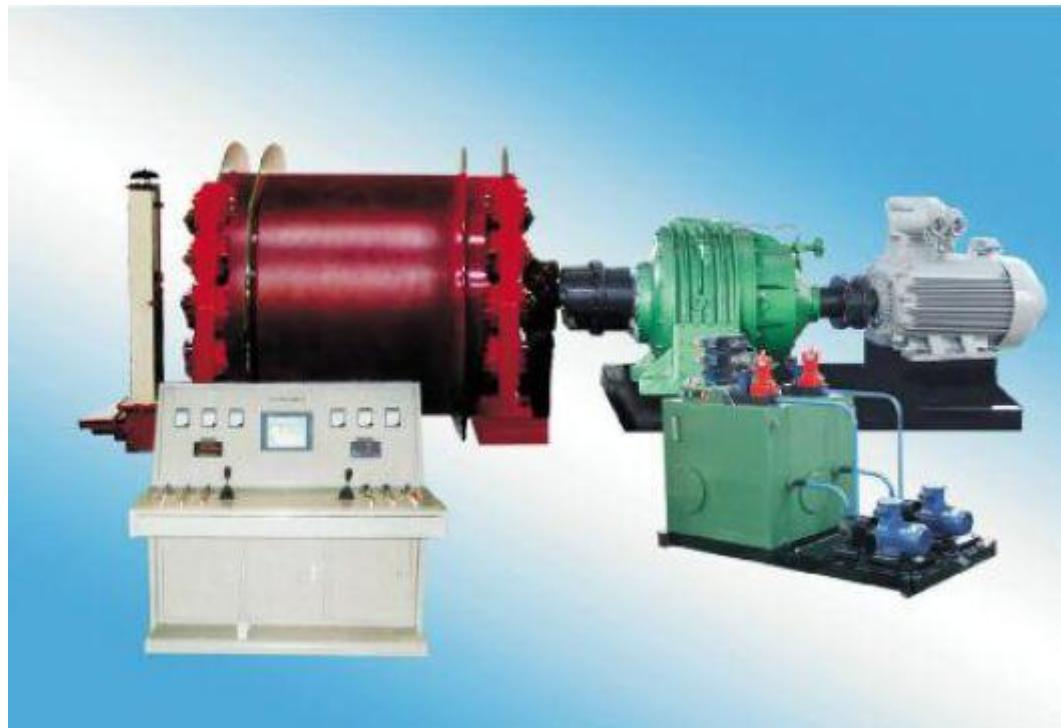
矿井提升机和矿用绞车是担负矿山地面与井下各工作水平面之间人员、材料运输任务的关键设备。产品细分为防爆液压提升机（绞车）、单绳缠绕式矿井提升机和矿用绞车、多绳摩擦式提升机。
