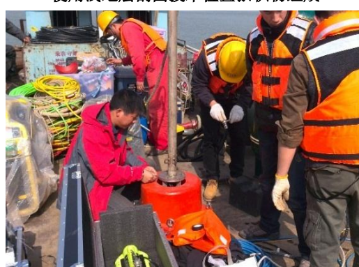
使用浅地层剖面技术检查淤积物组成
