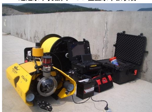
通过水下机器人 ROV 检查水下淤积物
