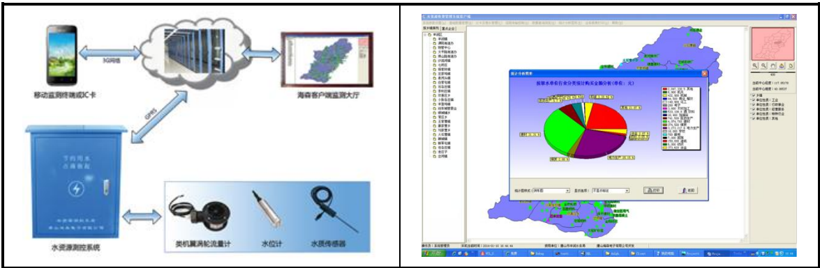
图 7：水资源实时测控系统流程图及系统界面
