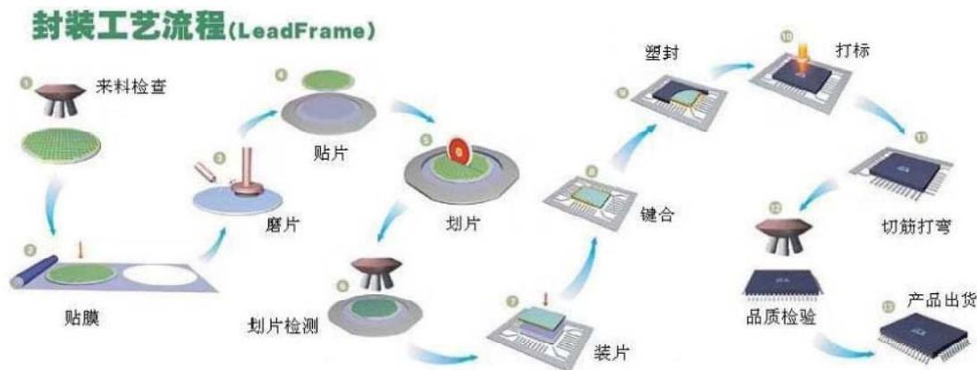
半导体封装程序中的装片、键合、塑封等工序即为半导体封装的主要工序，各工序所需使用的封装材料分别为引线框架、键合丝、塑封树脂。半导体封装不仅起着安装、固定、密封、保护芯片及增强电热性能等方面的作用，还通过芯片上的接点用导线连接到封装外壳的引脚上，这些引脚又通过印刷电路板上的导线与其他器件相连接，从而实现内部芯片与外部电路的连接。公司的主要产品为半导体封装用引线框架，具体可分为分立器件封装用引线框架和集成电路封装用引线框架两大类。公司重视新产品的开发及技术储备，并根据客户的需求，不断改
