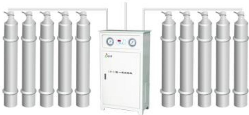
由两组若干氧气瓶组成，两组之间实现手动或自动切换，自动控制由PIC及压力传感器实现。具有供气工作状态显示、换瓶声光报警功能、断电持续供氧等功能。作为医院备用氧源以及小型医院氧源。但其氧气来源依然为高压氧气瓶，在经济、安全以及便利性上较差。
