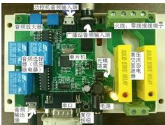
(b) 可自动启动“大喇叭”的音频控制器
