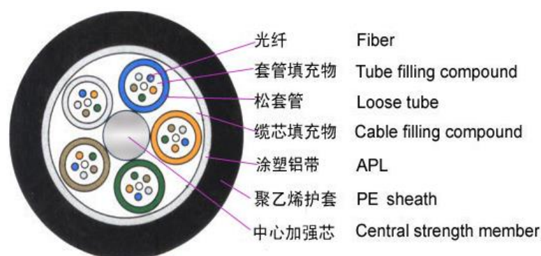
图 2：光缆结构示意图
