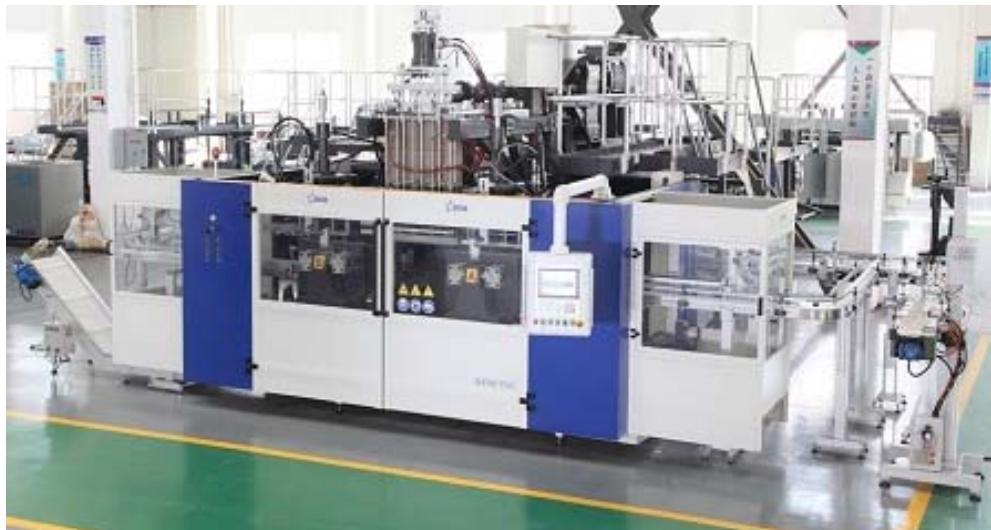
该系列产品为公司自主研发、制造的全自动中空成型机，挤出机采用直联结构，挤出量在原有基础上提高 15%-20%，控制系统配有 10.4 寸 TFT 真彩操作屏，系统内置 100 点型坯壁厚控制器，控制精准、制品壁厚均匀，可有效节省原料，提高工作效率。该系列机型都拥有 A、B 两个工位，每个工位根据客户的生产要求可配置 2-8 个型腔，使得单次出瓶个数大大增加，可满足客户对日均产量的高要求，成为同行业的竞争优势，为客户带来可观的收益。
