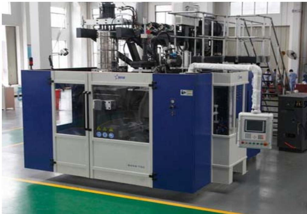
该系列产品为公司自主研发、制造的全自动中空成型机，挤出模头采用双层补偿分流梭的单层模头，液压系统采用伺服变速泵驱动，具有更高的能量效率，比普通油路节能 40%，PLC 控制，彩色触摸屏操作，并特别设计了外置打飞边装置，合理安排了机器布局，人工只需将设置要求通过人机界面输入后一键式启动，设备将自动完成上料、挤出、吹塑、切飞边等动作，工作劳动强度低，一人可看管多台设备操作。帮助用户淘汰以往落后的加工方式，解决企业用人问题、场地问题，提高生产加工效率，减少整个生产环节的生产成本。
