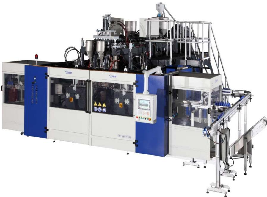
该系列产品为公司的核心技术产品，挤出模头采用心形流道的多层次共挤模头，流道的设计基于精确计算，流线型、无死角，能够快速换色，还可根据客户要求增加可视液位线的设计。液压阀采用 Bosch Rexroth 品牌，稳定可靠，精度高，液压系统运行平稳，PLC 控制精确，长年油温在 40-50℃，吸油和回油采用双过滤，使液压油及液压元件使用寿命更长。该系列机型可以使用多种不同原料生产塑料包装容器，满足客户对特殊包装容器的高要求，能够广泛适用于 PE、PP、PC、PA、PVC、PETG 和 EVOH 等多种原料。
