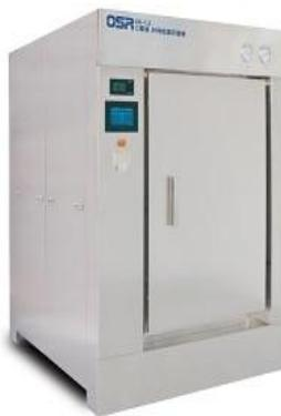
该系列灭菌柜主体采用卧式矩形结构，具有标准 GMP 验证接口，方便用户随时进行设备验证。密封门采用电动升降结构，操作简单；采用广角、雾状喷淋，确保柜内无死角，提高温度的均匀性；该系列产品采用德国 GEMU 气动阀，威乐水泵等最优化配置。
