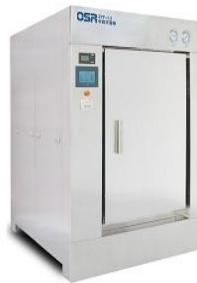
该系列产品主体由内外二层组成，具有标准 GMP 验证接口，方便用户随时进行设备验证；密封门采用电动升降，操作简单、安全可靠；保温采用硅酸铝棉，保温性能好并具有独特的冷凝水控制技术。
