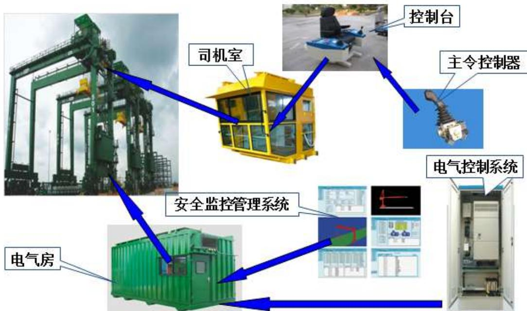
公司起重机械成套电气控制系统由主令控制器、控制台、司机室、电气房、电气控制系统、安全监控管理系统，配以其它电子元器件构成，成套电气控制系统在应用现场通过profibus、工业以太网等现场总线通讯方式与控制台、现场仪器仪表等部件进行数据通信，完成控制起重设备运行的所有工作。
