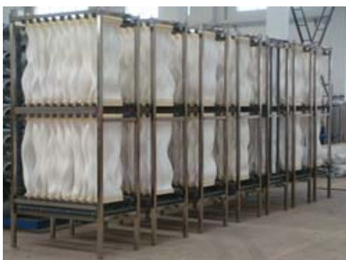
公司为嘉兴锦福缩染有限公司印染废水处理项目 研制的内置式 MBR 膜设备
