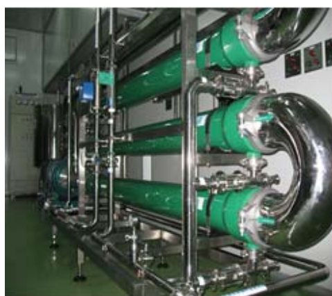
公司为广州星群（药业）股份有限公司药液研 发的管式 UF 超滤设备
