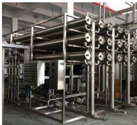
公司为福建海峡生物工程有限公司研发的特种 RO 膜设备
