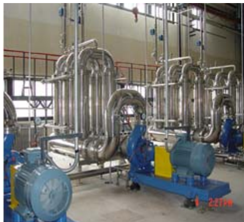
公司为吉林敖东延边药业有限公司中药提取 研发的 CMF 无机陶瓷膜设备
