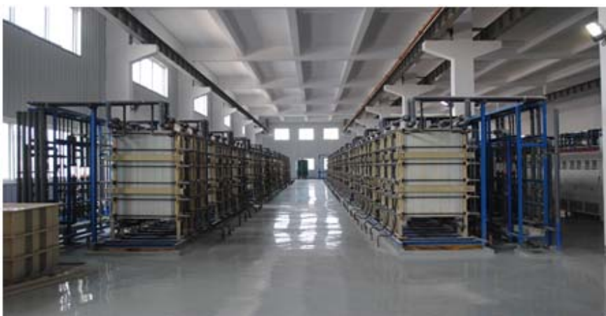
公司为新疆石河子拓北工业园综合废水零排放 研发的 EDR 电驱动膜设备
