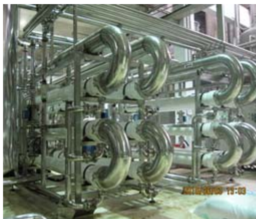
公司为大闽食品（漳州）有限公司研发的 的管式 UF 超滤设备
