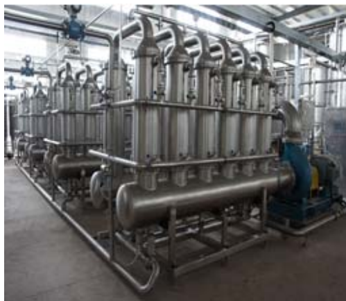
公司为大闽食品（漳州）有限公司研制的 CMF 无机陶瓷膜设备
