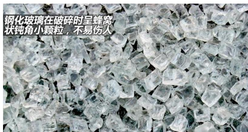
钢化玻璃主要适用于设计时速低于 40km/h 的机动车前风窗、所有机动车风窗以外玻璃包括车门、角窗、侧窗、后窗及顶窗玻璃等，建筑用幕墙、门窗等。区域钢化玻璃适用于不以载人为目的的载货汽车（N 类汽车）、不适用于以载人为目的的轿车及客车等；
