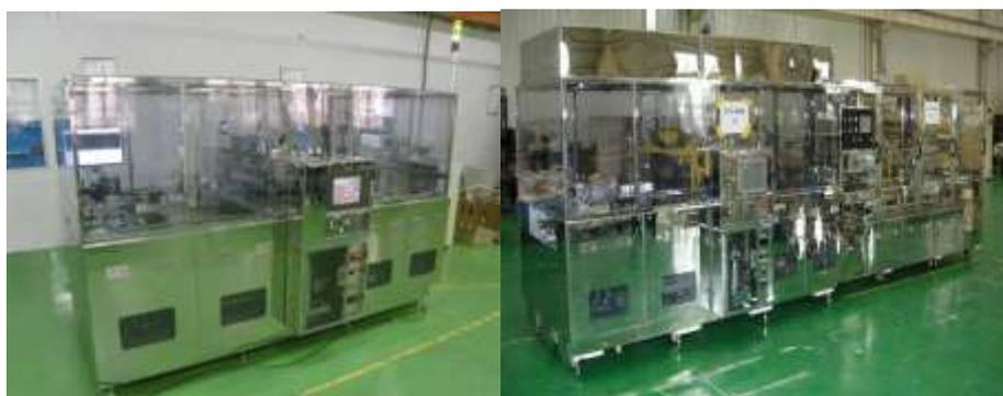
②Rubbing 摩擦机：该装置利用旋转滚轮对玻璃基板进行配向处理。摩擦机按照人工设定的角度，并按触摸屏设定的摩擦深度、摩擦滚轮转速和工作台进给速度进行摩擦。
