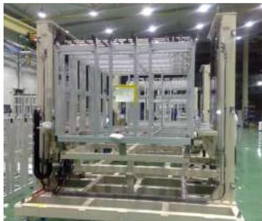
**INDEX (收发料设备):** 用于连接主设备和自动化物料储运系统, 它为搬送机器人提供安全的操作空间, 且为传送基板玻璃卡盒提供端口平台。
