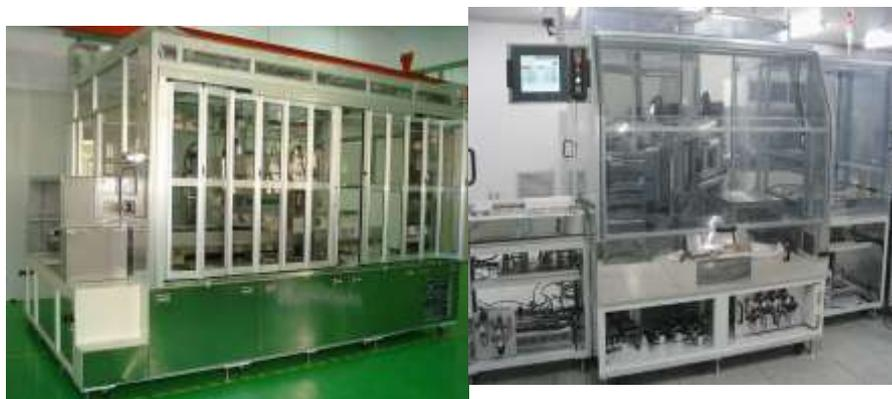
③丝网印刷机：主要用于 LCD 板的封装印刷及其它小型产品印刷，可与自
