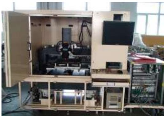
③图形短路检查仪：用于 ITO 板图形线路的短路检查，根据被测图形基本形状尺寸进行设置后在计算机控制下完成整板的自动测量。
