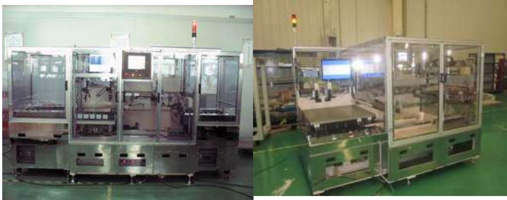
④小尺寸 US 清洗机：该清洗机相较于高世代线 US 清洗机尺寸偏小，原理基本相同：该装置采用超声波喷嘴和真空腔共同清除尘粒。LCD 玻璃在运行过程中表面会形成一层空气附着层。超声波可以有效破坏该附着层，从而使包裹在附着层内的微小灰尘颗粒分离出来，最后被真空吸走，达到清洗的目的。玻璃进入此设备，被吸附在工作台上。滚珠丝杠带动超声波清洗头通过玻璃上方，对玻璃进行清洗。清洗后的玻璃由滚轮传送至下一工序。
