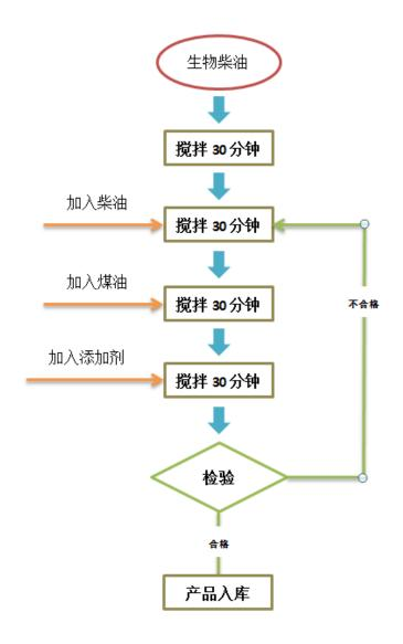
流程说明:添加剂种类较多,且根据不同指标和质量要求,添加剂品种和数量有所区别。加入柴油、煤油和添加剂的作用为降低产品闪点、密度和凝固点。 完成调合后进行指标和质量检验,合格产品入库,不合格将继续回调加工。
