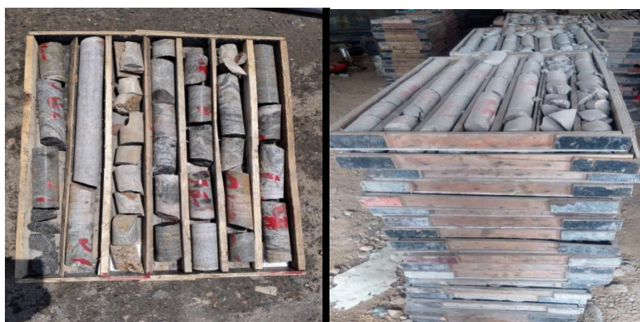
钻探工程取样（岩芯）示意图
