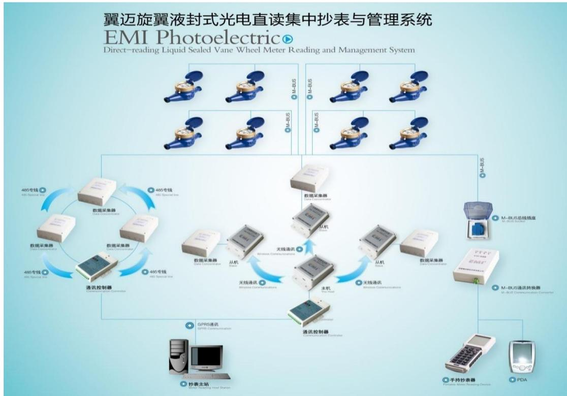
公司产品采用无源光电直读技术，并通过水表与数据采集器、集中器之间的数据传输以及水表与水表之间的数据传输将水表读数上传主站，实现智能化抄表工作，节约人力成本。
