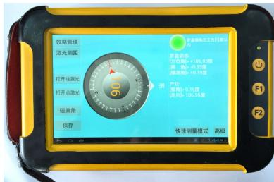
A yellow and black handheld device with a color screen and physical buttons. The screen shows a compass-like interface with data and a '90' value. | 该仪器基于公司 1 项专利技术研制而成，实现对岩层产状、距离的非接触式测量，具备施工现场拍照、录像取证与地质编录等功能，实现了对施工现场方位、地形、地貌、地物等数据的采集、处理、定位、导航、通讯等。该仪器是最新的地质测量智能装备，具备接入物联网及云计算功能，可提供远程技术服务。可广泛应用于地质调查、环境评价、安全工程、矿山地质与地下工程等领域。 |
