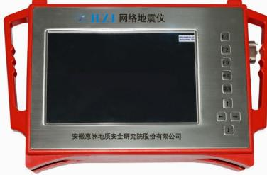
A red and black handheld seismometer with a color screen and various buttons. The screen displays the text 'X HZI 网络地震仪' and '安徽惠州地质安全研究院股份有限公司'.    | 该仪器利用地震波勘探技术，具有分布式智能采集地震、微震数据功能。是新一代智能物探装备，具备接入物联网及云计算功能，可提供远程技术服务。应用于资源与岩土勘查领域。在煤矿具备槽波地震勘探、工作面震波 CT 探查煤层断层、陷落柱等地质异常；在资源领域可进行二维、三维地震勘探；在非常规能源领域可进行压裂监测等。                      |
