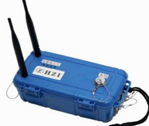
A blue rectangular device with two black antennae and a cable. It is designed for wireless data transmission.                                       | 该仪器利用工程地震勘探技术研制而成，采用智能无线组网，构建多基站无缆式地震仪器系统。具备接入物联网及云计算功能，可提供远程技术服务。应用于矿山、隧道、水利、地铁等领域中的快速地质构造扫描与灾害源探查。                                                                          |
