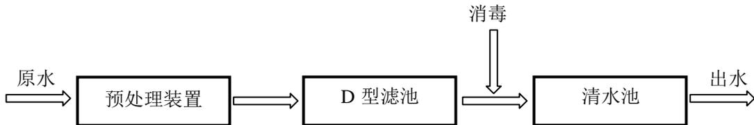
D 型滤池过滤工艺目前已经十分成熟，具备高精度、超高速、耐冲击性强、纳污量大、自动控制工艺简单、加药量少、运行费用低、出水水质优等特点。D 型滤池过滤工艺的核心技术是“一种蝶型高效自调适塑纤混合滤料过滤体”，公司拥有该过滤体的发明专利，并在新疆的大、中型水厂项目实现产业化应用。
