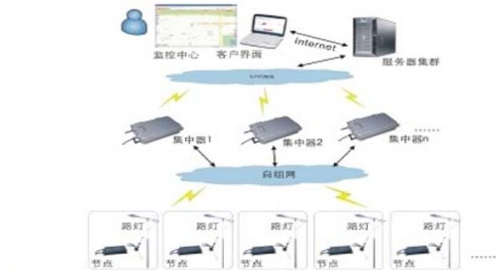
通过终端的节点控制器（ZL201320448508.9），可实现基于单灯或分组的路灯亮度调节和开关控制，同时采集灯的电压、电流、温度、能耗故障分析、调光比例等信息，为远程灯状态诊断、故障报警、电缆防盗等提供依据。该系统由监控中心、集中器、节点控制器三部份组成。
