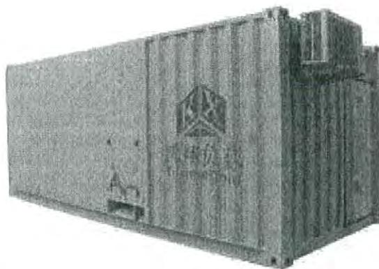
高压交流负载柜可直接测试 10.5 千伏以上的高压发电机组，无需通过变压器来中转，因此性价比更高、测试结果更准确。高压干式负载主要用在核电站、数据中心等领域，安全性高，电阻安全距离超过国标，满足这些领域对安全的高需求。能够一台负载同时测试多台高压发电机组，可提供稳态测试、整定测试、波动测试、突加测试、突卸测试、谐波分析、录波分析。
