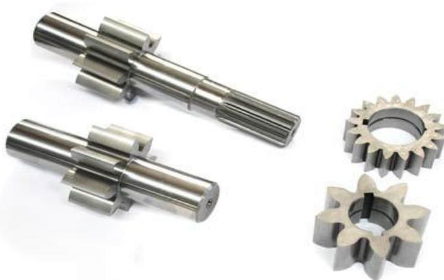
(3) 斯太尔机油泵齿轮。产品经过渗碳淬火和磨齿工艺加工处理，用于斯太尔重卡的机油泵上。产品具有运转平稳、产品强度高、使用寿命长以及能够在恶劣环境下正常使用等特点，是国内发动机经常使用的机油泵齿轮。
