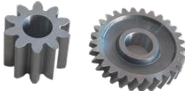
(4) 81D 机油泵齿轮。产品经过调质、磨齿和氮化工艺加工处理，以泵外齿传动带动一对泵内齿轮传动后产生油压输油，应用于长城 GA2 乘用车发动机。产品具有强度大、油压稳定、噪音低和高精度等特点。
