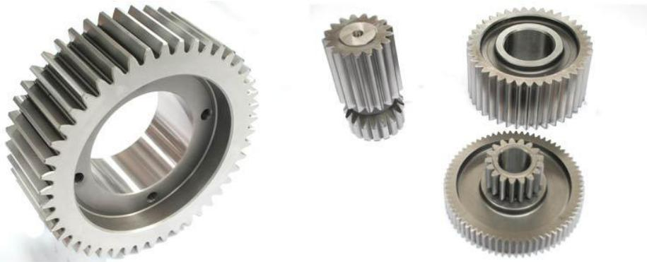
(4) Cummins PTO 总成，用于 Cummins ISG 发动机，这款发动机是目前康明斯公司较先进的发动机。该发动机主要出口巴西、美国和俄罗斯市场，采用日本进口 NSK 轴承和德国进口 NSK 轴承进行装配，具有输出扭矩大、传动平稳的特点，是 Cummins 发动机最新的动力输出结构。齿轴采用等温正火、渗碳和 KAPP 磨齿加工，具有无磨削烧伤的特点，使得产品的可靠性高于同类产品。
