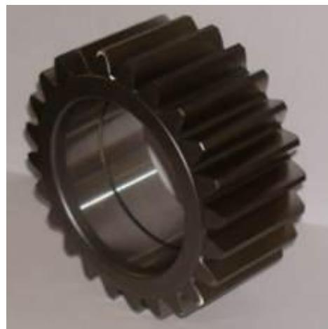
(6) 三一重工齿圈。供应三一重工北京分公司，产品经过调质、中频淬火和磨齿加工工艺处理，用于三一重工工程车上，是回转结构的重要支撑者。产品尺寸大、强度高、传输扭矩大、耐磨，能够在恶劣环境下长期工作。
