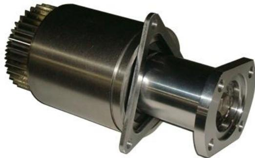
(5) 意大利卡拉罗齿轮。产品经过渗碳、磨加工和磨齿加工工艺处理，内孔粗糙度达到 Ra0.2 以内，用于卡拉罗汽车后桥装置上，是重卡后桥齿轮。卡拉罗产品具有精度高、强度大的特点，产品的可靠性强。
