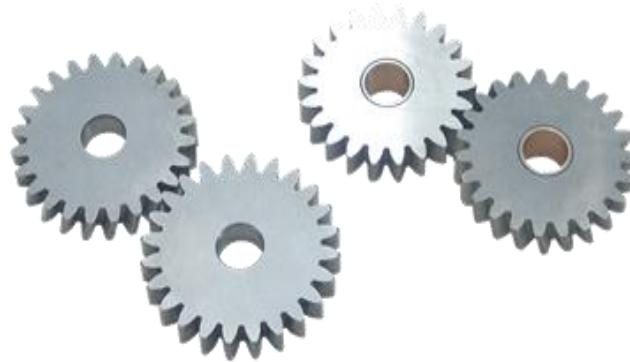
(2) 卡特彼勒高、低压泵齿轮、齿轴。产品经过渗碳淬火、磨齿和精研外圆工艺加工处理，用于卡特彼勒挖掘机油泵上。齿轮具有强度高、使用寿命长、运转平稳以及噪音小等特点，主要出口美国市场。
