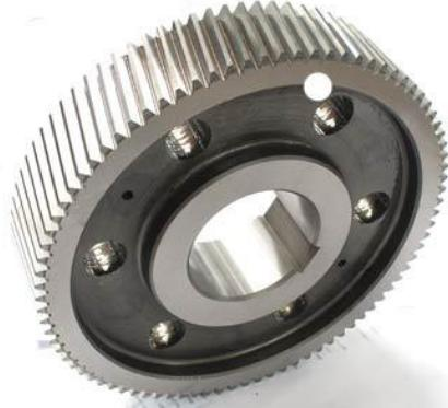
(3) 九洲四维减速机齿轮。该齿轮用于行星减速机，产品经过磨齿、插齿和渗碳工艺的加工处理，具有精度高、噪音小、传递扭矩大、传递效率高、结构紧凑等特点，被广泛应用。此外，行星减速机的体积小、传输效率高的特点使得其性能更优越于其他类的减速机。
