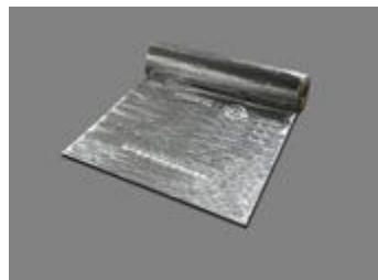
无胎自粘聚合物改性沥青防水卷材是由自粘橡胶沥青胶料、PE膜、铝箔 AL 及隔离材料组成。具有超强粘结力，自粘施工安全可靠。自粘橡胶沥青的配方国内一流，多项物理指标优于行业内同类产品。适用于多种防水工程要求。双面自粘卷材可与多种材料复合使用，构成多道防水系统。
