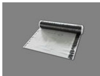
SPPE 高分子聚酯复合自粘防水卷材（赛力克 S，高分子 Polymer，聚酯 Polyester，故取代号 SPPE）是一种采用高分子聚酯膜作覆面材料、复合 HDPE 高分子基材，再涂覆“胶质硅酸钙蠕变自粘胶”而制成的高性能的复合自粘防水卷材。该材料集高分子材料与自粘卷材优点于一身，其抗拉强度和耐老化性优良，大大提高防水效果。其表面聚酯膜美观，在气温较高的情况下施工，很好的解决了其它自粘卷材易起鼓的现象。卷材施工完毕后还可直接在其上绑扎钢筋或浇筑混凝土，地下室侧墙外防水施工后可直接回填土，不会构成对防水层的破坏。
