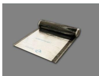
PET 聚酯复合自粘防水卷材是公司推出的一种经济、实用、环保型新材料。采用聚酯复合膜（镀铝、铝塑复合）为表面材料，覆以橡胶改性沥青胶料及隔离材料组成，用水泥浆粘贴。可在潮湿基面上施工，对基面要求低，具有粘结强度高、粘结效果好、不窜水等特点。
