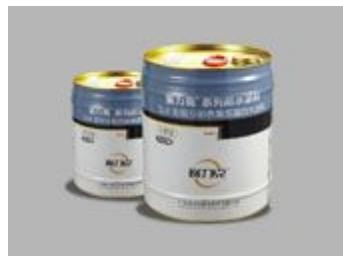
双组分聚氨酯防水涂料是双组分反应固化型防水涂料，A组分以异氰酸酯、 和聚醚为主要原料反应制得的预聚体，B组分由增塑剂、固化剂、增稠剂、促凝 剂、填充剂组成的固化体。使用时将A、B两组分按一定比例混合，搅拌均匀后， 涂刷在需施工基面上，经数小时后反应固结成为富有弹性、坚韧又有耐久性的防 水涂膜。
