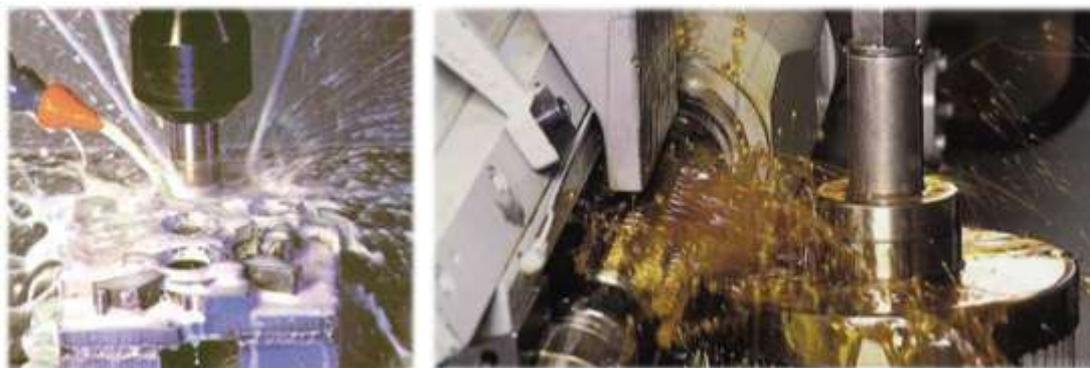
下图为应用聚晶立方氮化硼刀具的干式切削加工现场图片：
