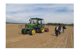
该技术是应用卫星定位导航自动驾驶进行农作物播种,驾驶员不再用手把握方向盘、离合器等驾驶操作去作业,由卫星定位系统完成播种工作,能一次完成双铺膜。1000米播行垂直误差不超过2厘米,接茬准确率达到2.5厘米,解决了农机播种作业中"播不直、接不上茬"的难题,既减轻了驾驶员劳动强度,又节约了土地,节省了种子,为秋季机采收打好了基础。
