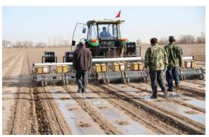
精量播种机械化技术是选用精良种子,创造良好种床,使播入土壤的种子行距、株距、播深满足农艺要求,覆土深度一致,达到底肥深施、单粒下种的一种农机化实用技术。通过精量播种技术可以使播种合格率可达到85%以上,播种深度(覆土厚度)合格率能达到95%以上,不间苗或很少间苗,不会对作物苗株造成伤害,播种质量好。种子精量播种入土后吸取营养成分趋于均衡,减少了传统播种苗牙发育时相互争水争肥的现象,精播的作物出苗整齐、分布均匀,强苗欺弱苗的现象不会发生,每一个单株都能在
