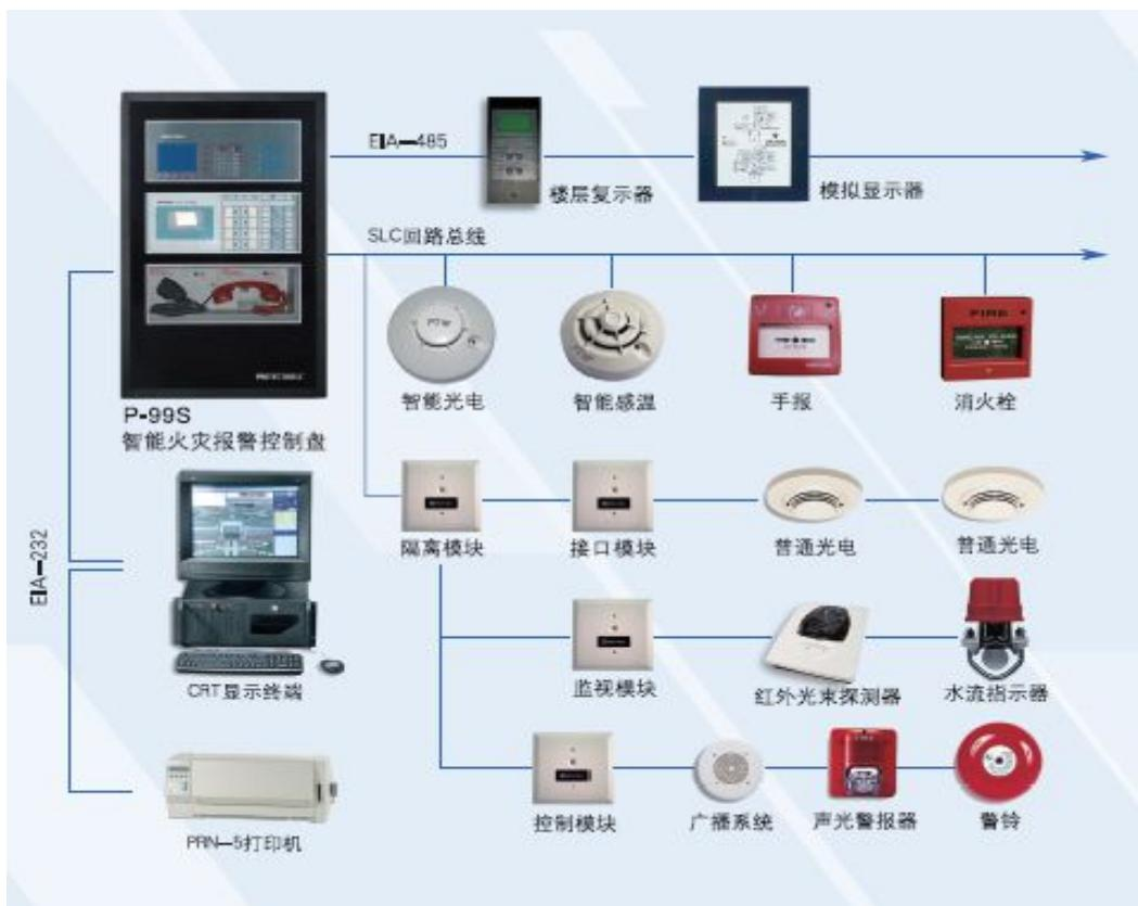
消防自动报警系统的主要功能是在火灾初期及时探测火灾信息（温度、烟浓度等），发出声、光报警，将报警信息（位置、地址）传递到报警控制器，并通过消防主控制器自动或手动启动现场各种灭火设施。
