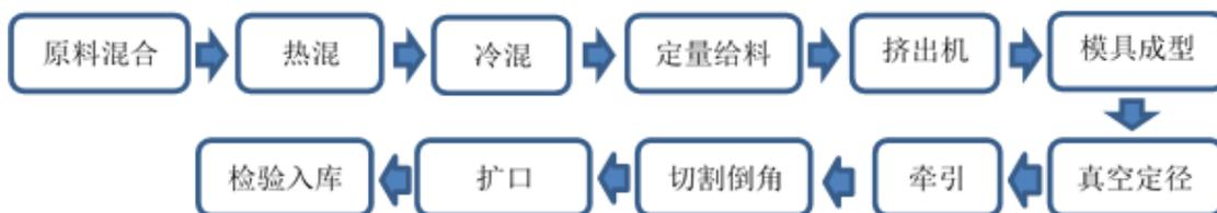
5) PE管生产流程
