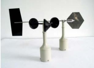
EC9-1测风传感器具有动态性能好、线性精度高、灵敏度高、测量范围宽、互换性好、抗风强度大等特点。适用于气象、军队、航空、海港、环保、工业、农业、交通等部门测量水平风参数的需要。 |
