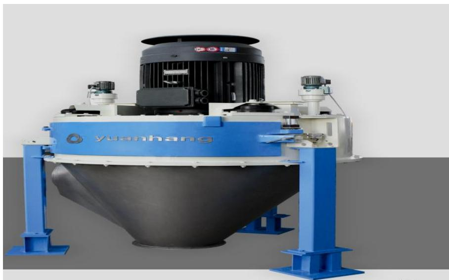
LFS-A08 系列立式锤片粉碎机是公司为了满足压滤工艺开发的新产品，该机采用立式结构，无需配吸风设备，锤片转子采用高速运转方式，运行噪声低，占地面积小，具有粉碎室温度检测、泻爆、筛框自动升降、堵料报警、可双向运行等优点。
