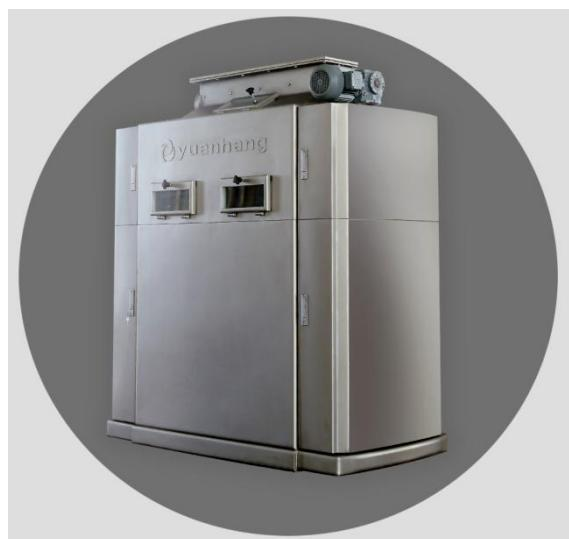
该设备淘汰了大米干粉碎、大米粉暂存、米粉调浆等多道工序的落后工艺，使供料、粉碎、调浆、冲洗、排污工序一次完成，通过自带醪液泵直接把大米粉浆从锅底输送到糊化锅，简化了生产程序。由于上述过程密闭，避免了物料氧化和粉尘爆炸的危险，提高了啤酒质量和安全性，改善了生产环境卫生。机械设备与自动化控制组合，实现了人—机对话与设备的远程操作，减少了操作工人的数量，降低了劳动强度。对温度、流量等重要工艺参数实现了高精度控制，使糊化温度、料水比一次满足工艺要求。
