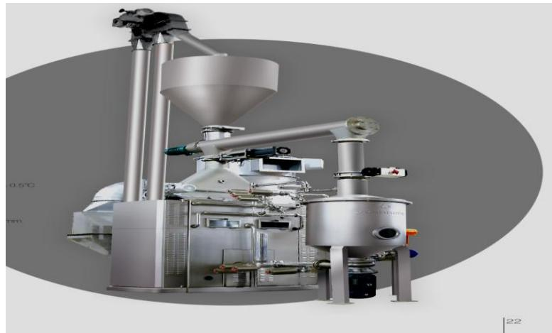
DMGF 系列淀粉调浆系统是公司根据市场需求开发的新产品，能使成品淀粉按一定的料水比快速均匀混合调浆，直接将料浆输送至糊化锅。系统由淀粉输送、粉料回收、暂存、均匀供料、调浆、CIP 清洗和控制系统构成，整套设备采用不锈钢材料制造，该系统具有结构合理、输送过程无粉尘、边下料边调浆、占地面积小、自动化程度高等优点，是淀粉调浆的理想设备。该系统可独立安装，也可与大米湿粉碎机组合成一套系统。
