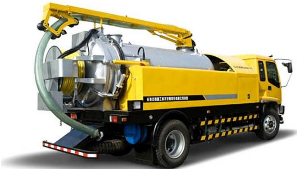
该车型主要用于下水道疏通，全自动作业减少环卫工人在下水道养护作业时的劳动强度及提高作业时的安全系数。
