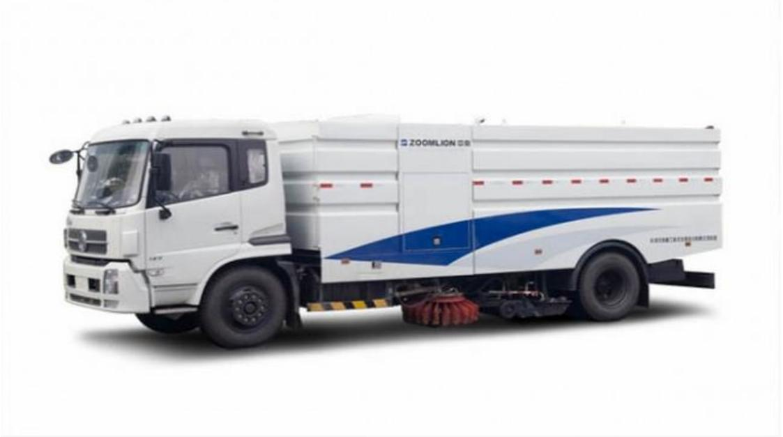
该车型是集扫路车和高压清洗车功能于一体的高效环卫车，具有路面清扫、路面清洗、路沿和路沿石立面刷洗、喷雾降尘、低压冲洗等多种功能。特别适用于城市广场、道路路面和路沿的高清洁度保洁作业，也适用于城市广场、道路路面和路缘的清扫、清洗等普通保洁作业。
