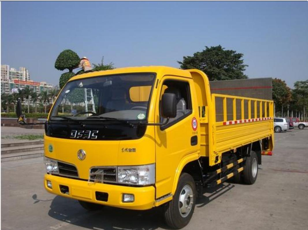
公司采用“以桶换桶”的垃圾清运模式，该模式中的主要设备即为桶装垃圾运输车，该产品可以一次性运输24个240L垃圾桶或9个660L垃圾桶，车辆尾部采用液压升降围板，该功能大大降低垃圾清运工人劳动强度，2人一日可轻松完成10-15吨垃圾运输。
