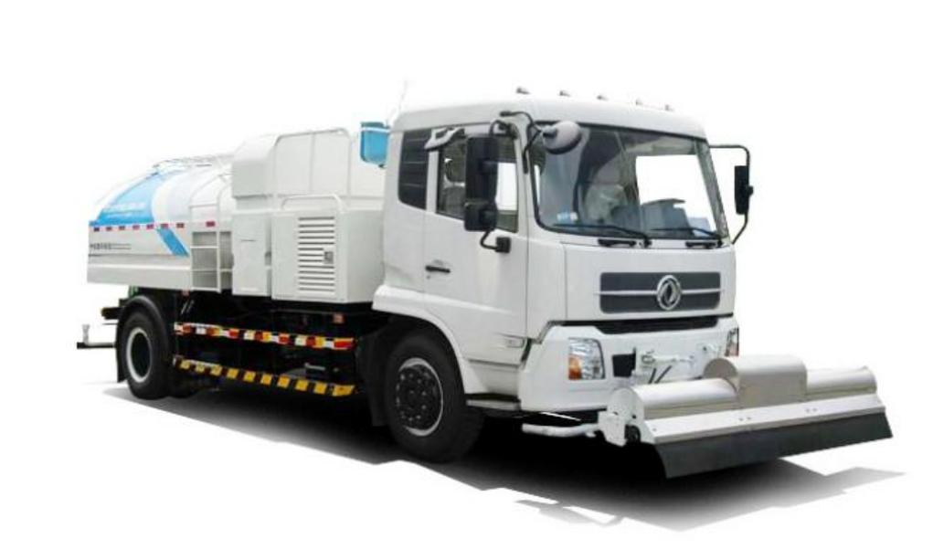
该车型主要用于路面的清洗工作，带高压洗地功能，适合于城市道路路面的原色回复、路面突击工作及开荒作业。车辆容积为12个立方，适合于大型车道的清洗作业。
