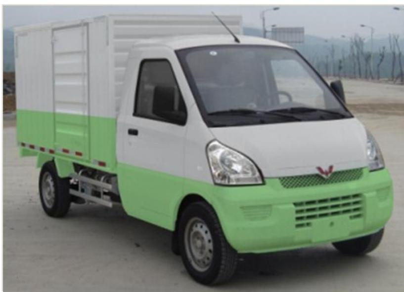
该车型作为前端垃圾桶运输的主要工具之一，采用微型底盘，适用于小型街道、厂区等大型机械设备不便作业的区域，一次性运输8个240L垃圾桶或3个660L
