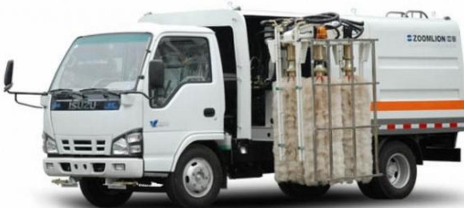
该车型是一种多功能城市道路、公路设施清洗设备，除具备高效清洗护栏的功能外，还具备高压清洗车所具有的路面冲洗功能，主要适用于城市道路中间隔离护栏、道路两侧护栏或道路两侧墙体的清洗，该车还配备高压冲洗水枪，可冲洗城市雕塑、交通标志、交通路牌、广告牌等。
