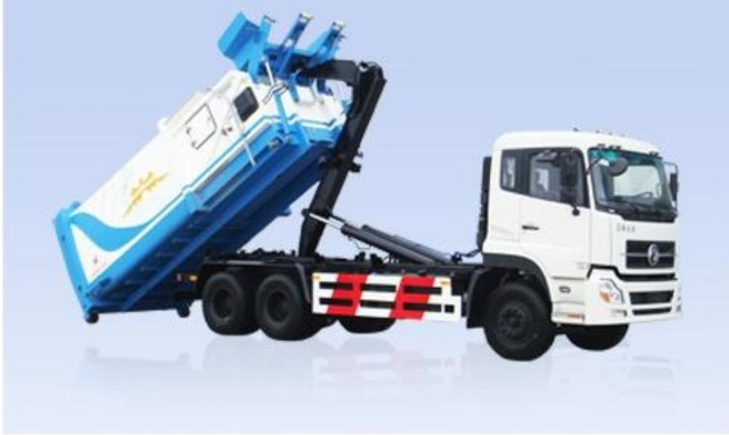
该车型是城市垃圾转运站进行垃圾收集和运输的专用汽车。主要负责垃圾压缩箱体从垃圾转运站转运至垃圾填埋场，一次性可以负责14-16吨垃圾的转运工作，减少公司的作业成本，提高工作效率。
