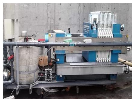
**应用领域：**工业污水深度处理及城市污水深度处理；废气脱硫脱硝。
