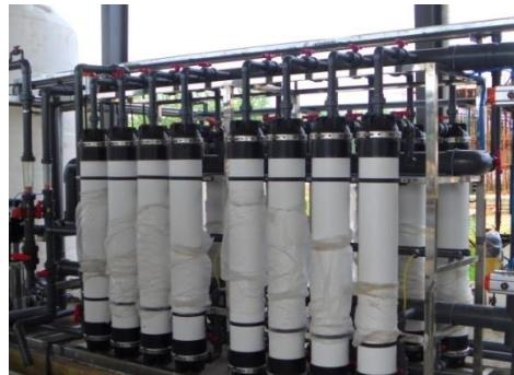
体积大于膜表面微孔径的物质则被截留在膜的进液侧，成为浓缩液，从而实现对原液的净化、分离和浓缩的目的。
