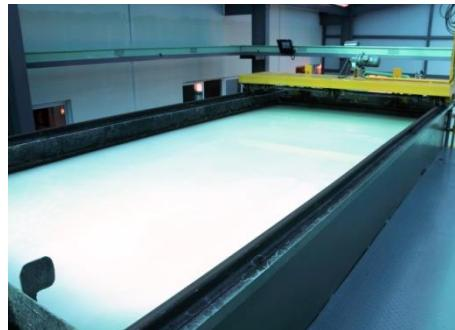
技术性能：运行稳定、易操作，易维护、低噪音；可实现一级回用，代替自来水用于磨边及洗涤工段，回用率大于 95%，运行费用小于 0.5 元/吨水。
